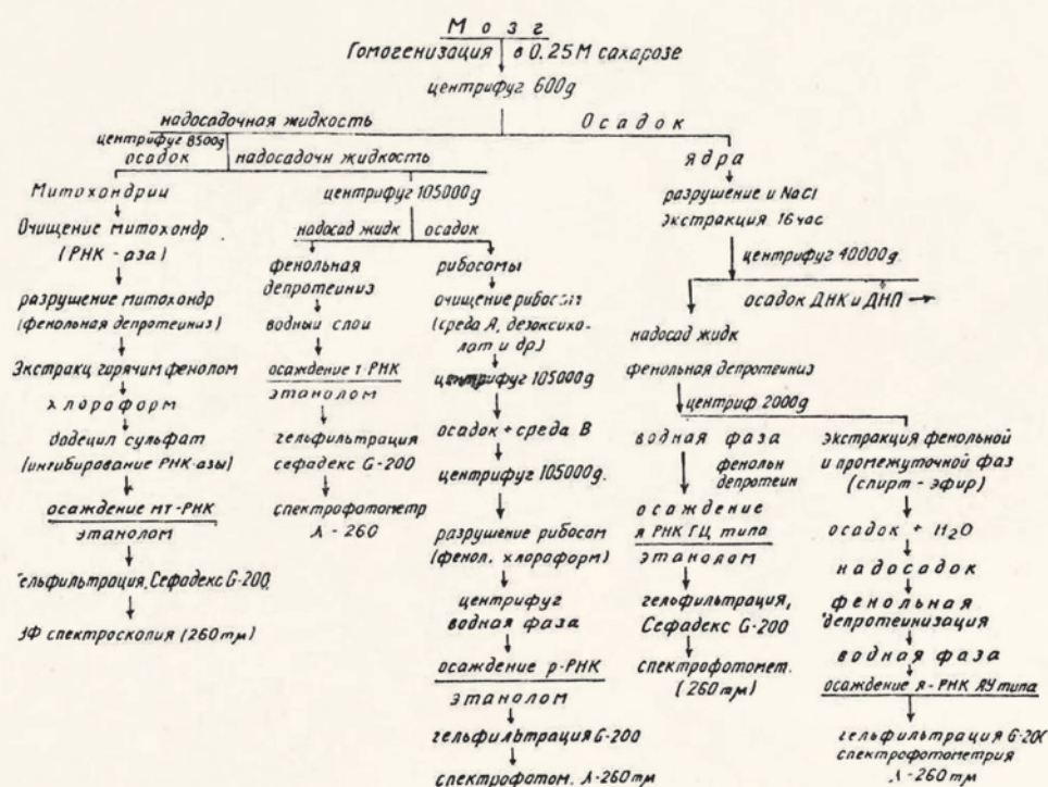
Рис. 1. Схема выделения и количественного определения различных форм РНК в мозгу комбинированным методом фенольной экстракции, дифференциальной ультрацентрифугации и гельфильтрации.
